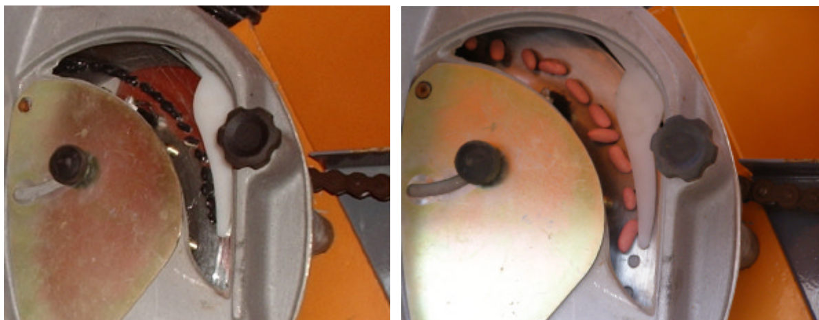
Figura 9: distribuidor neumático con poroto negro con 70 y blanco con 40 orificios (De Simone y Godoy, Salta 2008)
